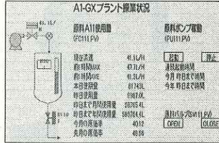
事務所PCから簡単に プラント操業状態が監視できる。 (パッケージ 600万円 PCサーバー 100万円)
